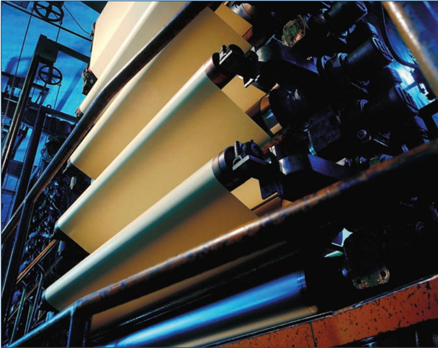
Kalander, Haspeln, Schneidrollen, Vakuumtrommeln sowie unterschiedliche Maschinengeschwindigkeiten erfordern ereignisorientierte, adaptive Überwachung.
