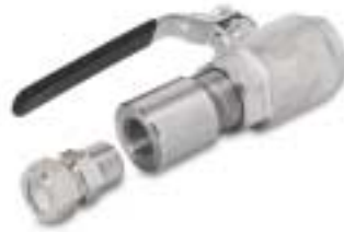
Adapter montażowy (PN 23166-00/01) musi być stosowany aby połączyć czujnik z zestawem zaworu kulowego 23240-00. Adapter zamawiany osobno.
