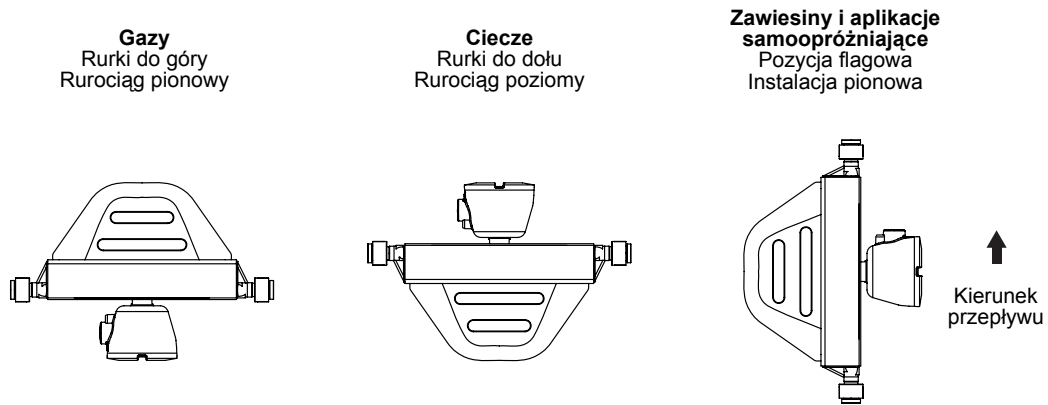
Ilustracja 4 Zalecane pozycje montażu czujników
