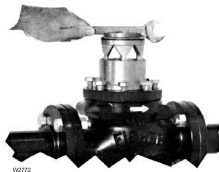
Ilustracja 9. Demontaż lub instalacja pierścienia gniazda i/ lub tulei przy wykorzystaniu korpusu jako dźwigni
