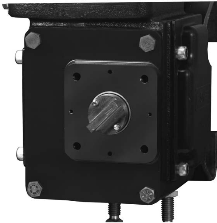
SPRZĘGACZ, PŁYTA MONTAŻOWA ZDJĘTA
