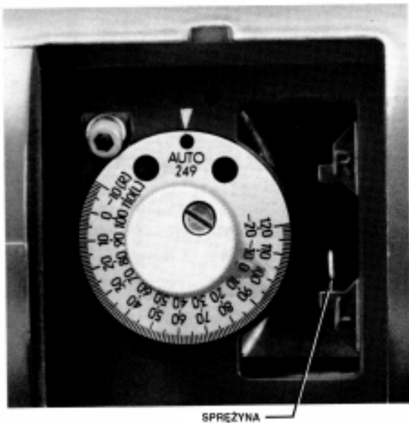
WIDOCZNA PODWÓJNA SKALA Z POKRĘTŁEM I WSKAŹNIKIEM SPRĘŻYNA ZNAJDUJE SIĘ W POZYCJI NEUTRALNEJ (ŚRODKOWEJ)
