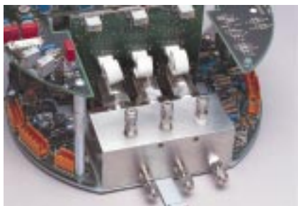
Patentierter elektronischer Durchflußkontroller im GCX
